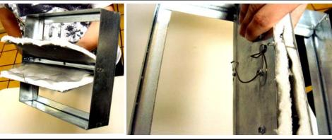
3. HOOK ONE END OF THE FUSIBLE LINK TO THE ROUND CLIP ON THE BLADE.
